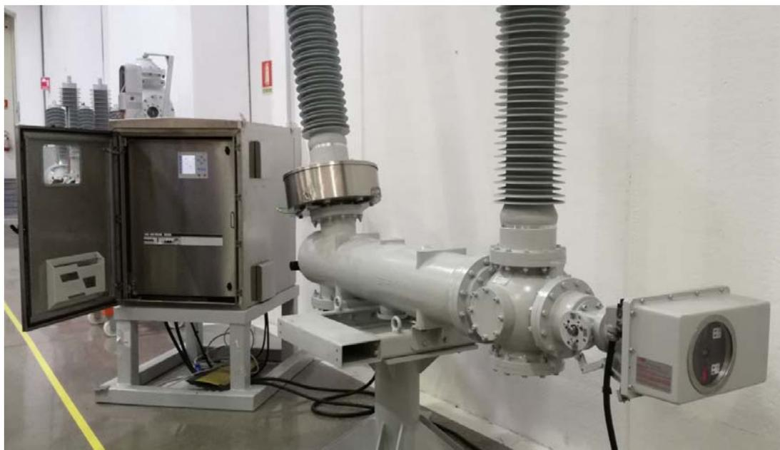
Сервопривод выключателя с цифровым управлением. (ABB)
