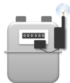
Gas Meter + radio module
